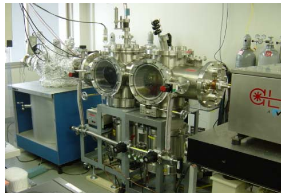
図 1 本研究に用いたレーザーデトネーション原子状酸素発生装置
