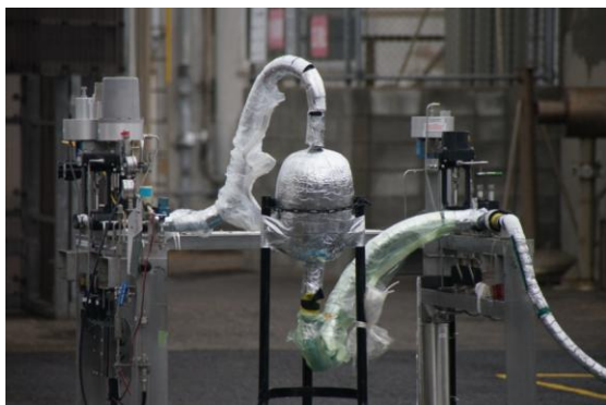
図 4.2-3 液体水素の充填および漏洩試験
