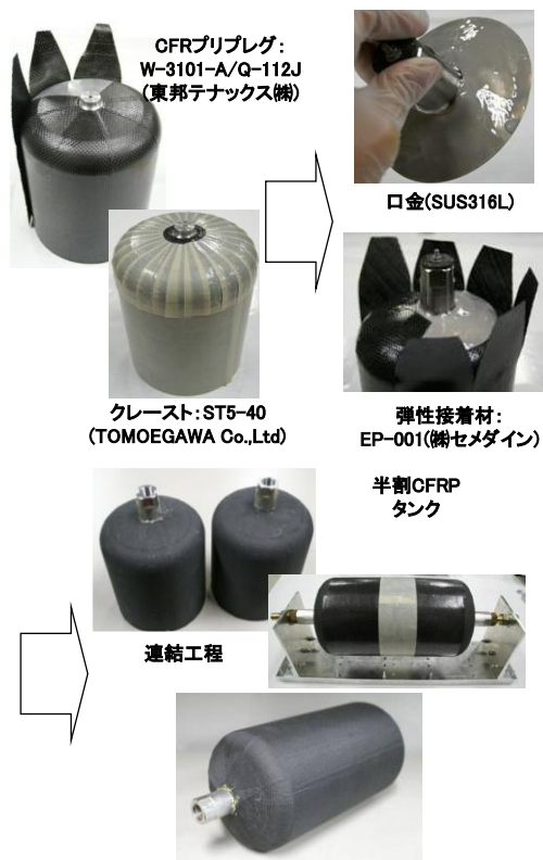
クレスト複合化CFRP液体水素タンク 図 4.2-2 クレスト複合化 CFRP 製液体水素タンクの成形工程
