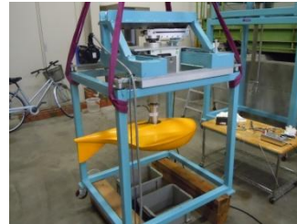
図 5 横方向強制動揺装置
