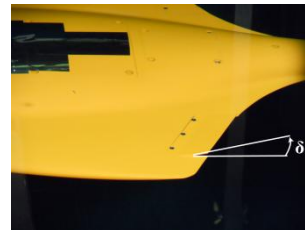
図 6 昇降舵角変更試験
