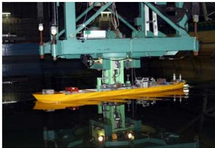
図 3 水槽実験(Circular Motion Test)の様子
