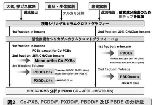
(2) 前処理及び測定法: 図2は、実験方法の概要を示している。生体・食品試料では、ホモジナイズ後、 $C^{13}$ -内標準物質を添加し、飽和シユウ酸ナトリウム水溶液、ジエチルエーテル、エタノール及びヘキサンを加えてそれぞれ振とうし、脂質の抽出、秤量を行った。そして、1N KOH/EtOH溶液で1時間振とうしながらアルカリ分解した後、液・液分配を行い、ヘキサン層にダイオキシン類を抽出した。精製は、積層シリカゲルカラムクロマトグラフィーにて分画し、さらに、活性炭分散シリカゲルカラムクロマトグラフィーにより精製し、窒素気流下で濃縮後、分析用試料とした。最後に、この試料は、キャピラリーカラム [定量用; SGE社製HT-8; 60m x 0.25mm x 0.25  $\mu$ m (特注品), 確認用; J&W社製DB-5] を用いて、高分解能GC/MS(日本電子社製; EI-SIM法)で定量
