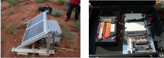
図2 開発した長基線電場観測システム
