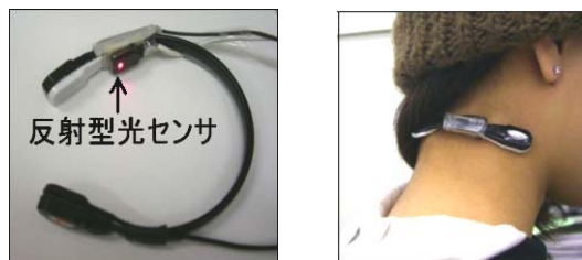
(a) ネックバンド (b) 装着時 図4 ネックバンド型パルスオキシメータ
