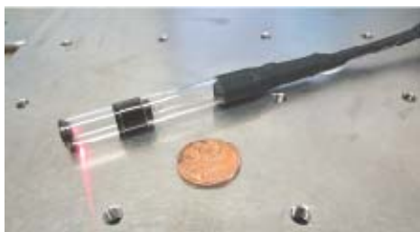
Fig.5 開発した3次元内視鏡
