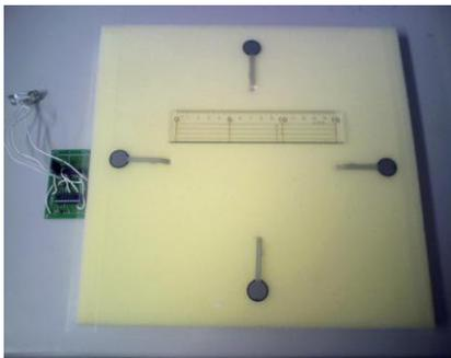
図1 荷重センシングシステム
