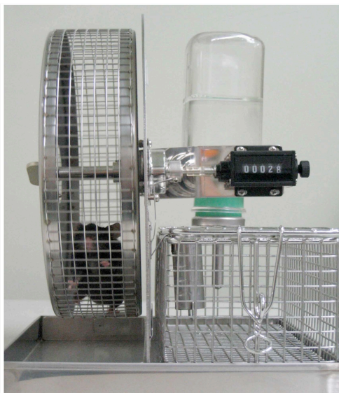
図1 自発回転ケージで運動するマウス 飼育ケージと回転ケージが一体型となっており、マウスは自分の好きな時間に、自分のペースで運動することができる。水と餌は自由摂取。
