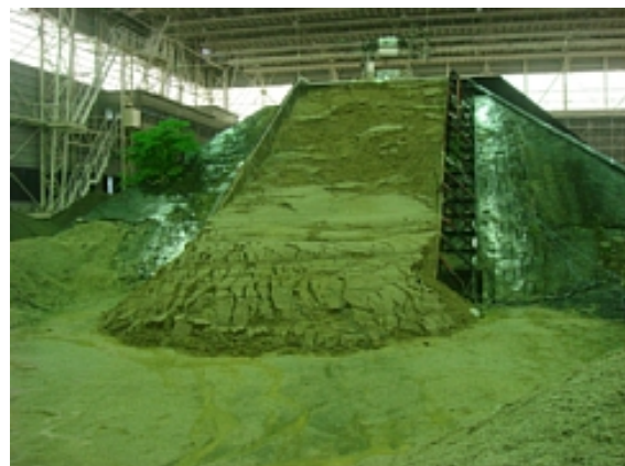
写真-2 崩壊後の実験斜面
