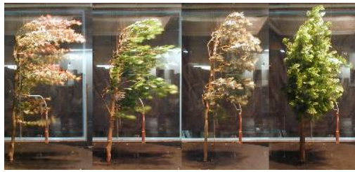
写真-1 強風下の樹木の変形
