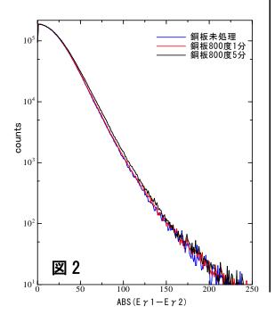
図2に未処理銅板と800度1分、5分のバーナー加熱処理銅板のスペクトルを示す。800度5分の加熱処理によるドップラー拡がりスペクトルの広がり方向への変化が見られる.この変化は750度50分の銅板資料では認められないので、ドップラー拡がりスペクトルの変化が認められれば750℃以上に加熱されたことを示していると考えられた。しかし、電気炉による加熱処理ではこれらの変化を検出できなかった。これは空気中の酸素による酸化膜の成長によって銅板の結晶構造変化が阻害されたためと考えられた。
