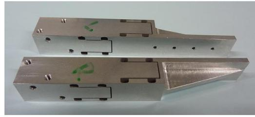
図6 H形スリット実験モデル
