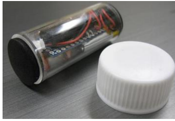
図 2. 製作した無線カプセル (長さ 40mm)
