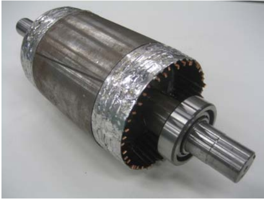
図3 試作した 10 kW 級高温超伝導かご形回転子の外観写真（高温超伝導線材として、Bi-2223 テープ材を使用）。
