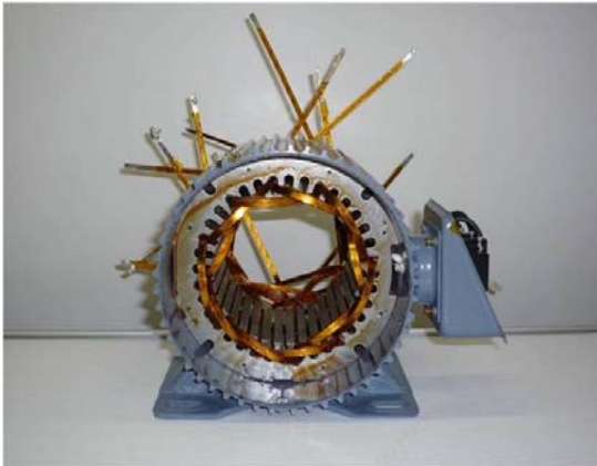
(b) コイルを固定子コアに挿入した状態
