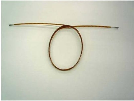
(a) レーストラックコイルの外観写真
