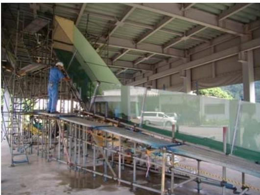
写真：高さ5.7mの大型岩屑なだれ実験装置
