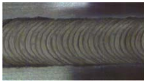
(a) スイッチバック溶接時の表ビード形状
