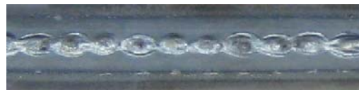
(c) 溶接実験時の裏ビード外観 図6 スイッチバック距離と裏ビード形状(溶接速度30cm/min、前進後退距離比2:1)
