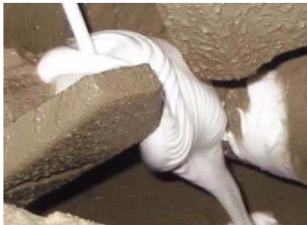
写真-3 PAE のミキサへの投入状況
