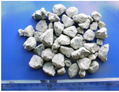
写真-5 再生骨材 M の外観
