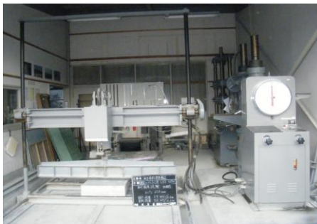
写真-6 製品の曲げ試験状況
