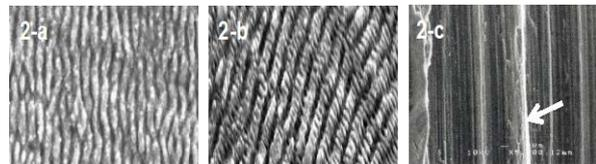
2-a 800 nmの高強度フェムト秒光パルス出力400  $\mu\text{J}$ 、1 kHzでパルス幅は120 fsを用いて照射したものは、幅約100~200 nmの縞状構造物が観察された。同じ条件で800  $\mu\text{J}$ のパワーで照射したものは、幅約600~700 nmの縞状構造物が観察される。
