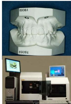
ィアの上下顎石膏模型を用いた。上下顎石膏模型は全顎模型計測装置 [Decsy Scan；デジタルプロセス（株）]
