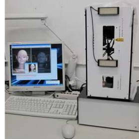
本計測装置では、装置中央に組み込まれたラインレーザーをミラーで反射させ、上下  $22^\circ$  の範囲を 1.6 秒で走査し、その投影された像を装置下方に取り付けられた CCD カメラで読み取る。また、ラインレーザー発振部の直上には
