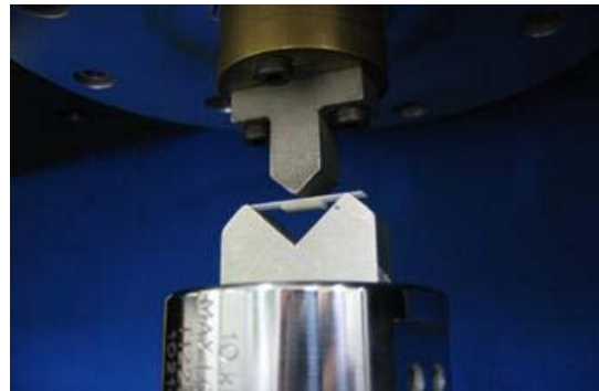
図2 ジルコニア焼成後の 3 点曲げ試験
