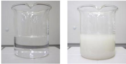
図 2 左: PMMA 単独、右: 2 wt%含有
