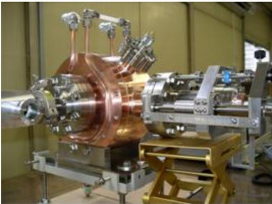
図3 1.5 GHz 高調波空洞
