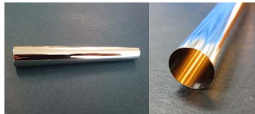
図6 回転楕円スーパーミラー(長さ 100\text{mm} 、直径 10.9\sim 15.5\text{mm} 、厚さ 50\mu\text{m} )
