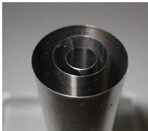
図 8 多重チャンネルミラーの組立外観
