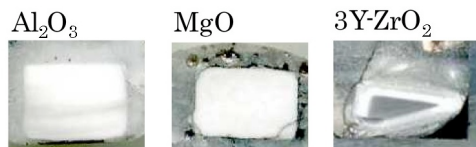
図 3. 溶融試験試料の断面の概観
