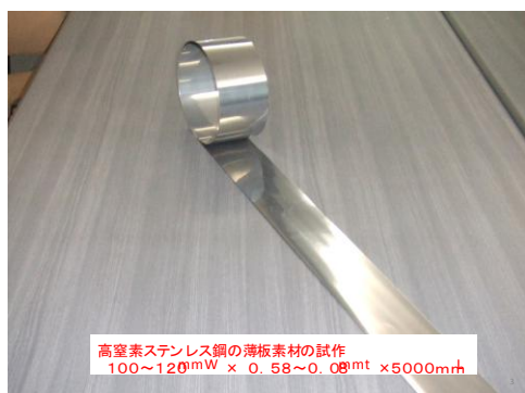
図5 板厚：0.1mmのHNS薄板加工試作材（幅：120mm）
