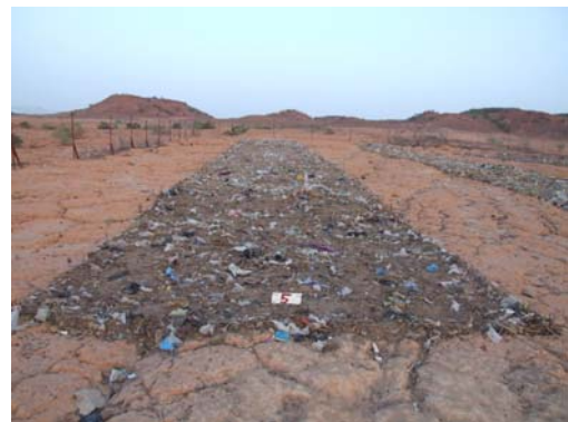
図1 ゴミ投入による緑化実験(2008年11月) [プロット5: 45\text{kg}/\text{m}^2 (5,400kg)のゴミを投入]
