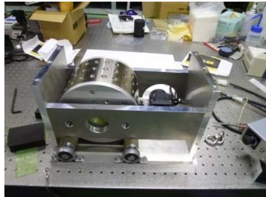
この開発したダイポール磁石は中心磁場1.6Tであり、直径は18cm、長さ12cm、重量20kgと極めて小型である。この小型マグネットの利用は磁場との相互作用長や磁場強度ではPVLASに劣るものの、複数の利点をもたらした。1つは、テーブルトップに横置きが
