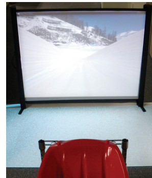
図 5 速度感覚増強効果を考慮したソリシミュレータ
