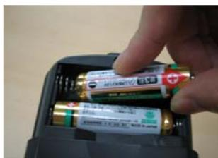
図1 乾電池装填作業
