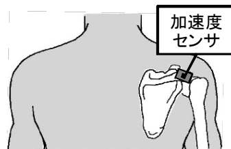
図3 加速度センサの位置
