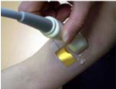
図2 筋動センサと超音波画像の同時計測実験
