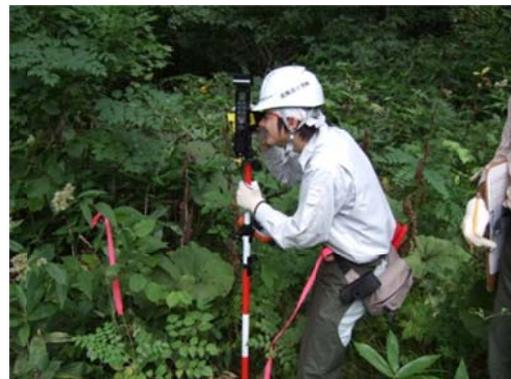
写真 2 レーザコンパスによる立木の測位
