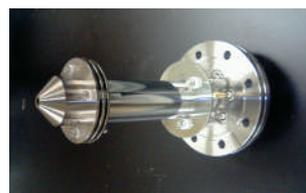
図2. 作成した質量分析器の写真
