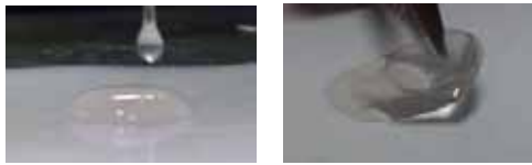
図3 光架橋剤による環動ホストポリロタキサン溶液(左)の紫外線(365 nm)によるゲル化(右)
