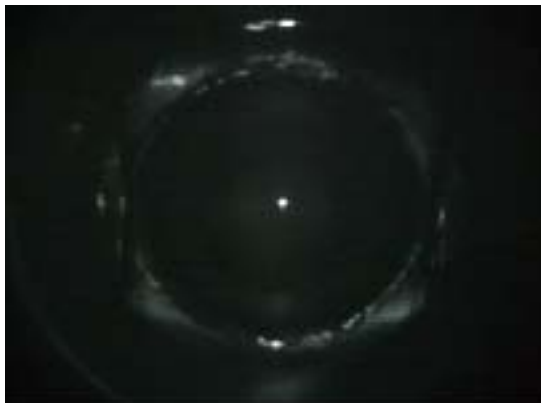
図2 冷却原子群。(中心の輝点が冷却原子群からの蛍光である)
