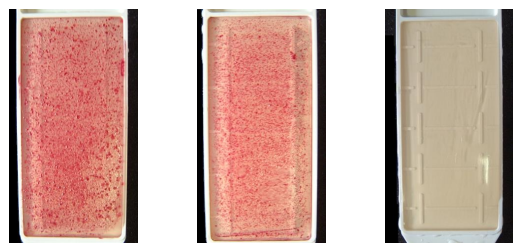
(1)放置した研削液に浸漬後 (2)ポンプのみで循環した液 (3)マイクロバブルを混入した液
