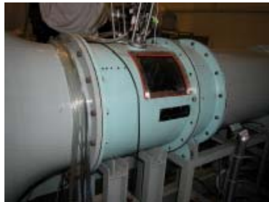
図3 環状タービン翼列風洞の測定部
