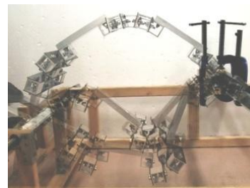
図7：振れバネの直列構造に基づく弾性構造体による大型カタパルト
