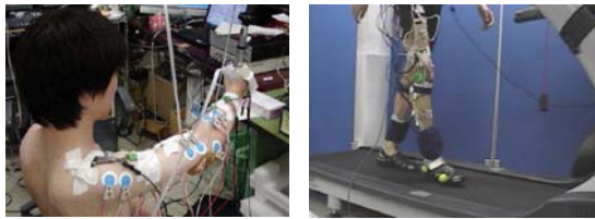
図 1. 筋電位計測と運動要素の抽出 (左：到達運動、右：歩行運動)
