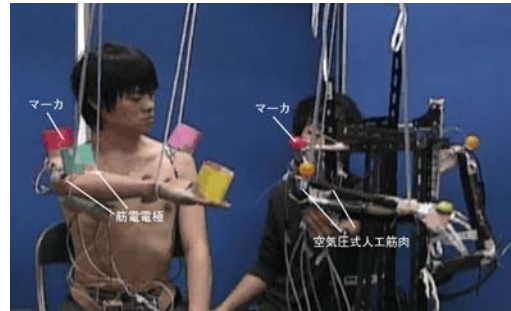
図 3. 筋電位情報を用いた筋骨格ロボットのマスタ・スレーブ制御
