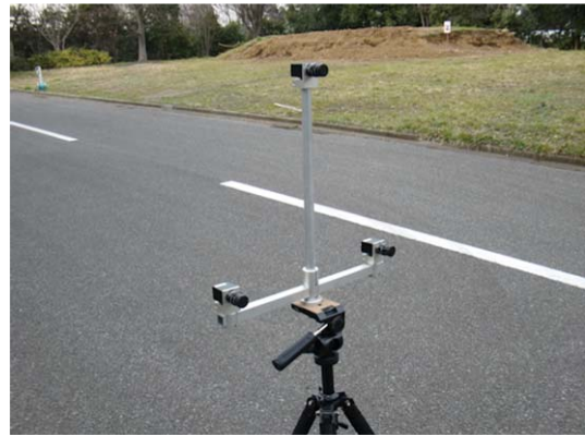
図-10 カメラ設置治具
