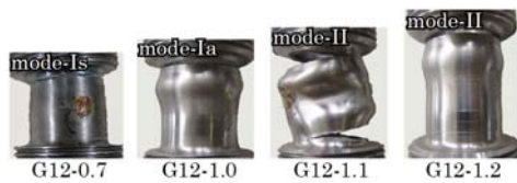
図 3.1.3 実験後の変形状況
