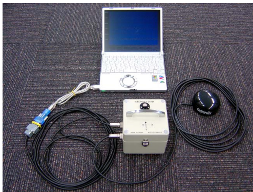
写真 1 1 点 3 成分振動計測システム
