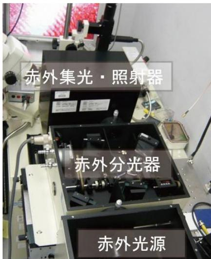
図2. 装置構成 (赤外光導入部)
