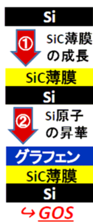
図1 グラフェン・オン・シリコン(GOS)成膜プロセスの模式図。
