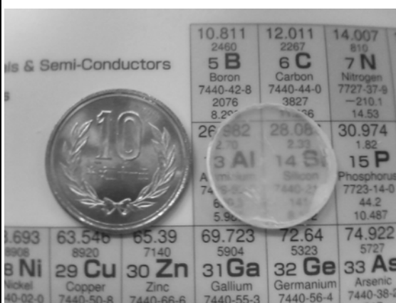
Fig.2 作製された Y 型ゼオライトバルク体
