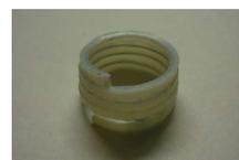
図 3 : SMP 製可変長コイル
