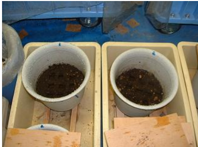
写真1 土壌中での溶脱試験の様子
