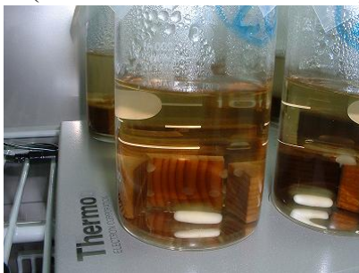
写真2 水溶液中での溶脱試験の様子
