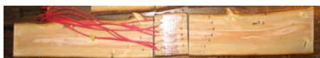
図3 根材の表面応力解放ひずみと柱目板を用いた応力解放ひずみ分布の測定
